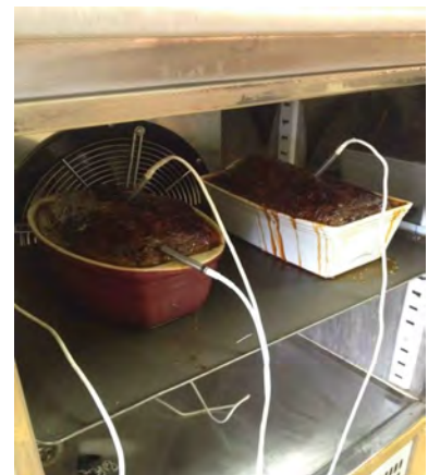
Tests de refroidissement de terrines, réalisés dans le Laboratoire d'Essais ACFRI
