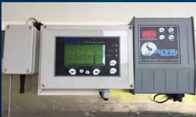
Chaque afficheur permet le pilotage et la traçabilité de 8 chariots. Le boîtier affiche en temps réel température durée du cycle et nom du produit.
