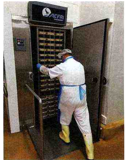
Clarelia a installé sur le site de l'un de ses co-traitants une cellule mixte Acfri CSP1-OL/P 850, série Compact. Le système est capable de surgeler 60 kg de produit par cycle de 120 min (pour faire passer de la viande de 4 cm d'épaisseur de 3 °C à -18 °C).
